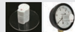
防爆対応の後付けIoT検針センサ (計器への装着状態)
